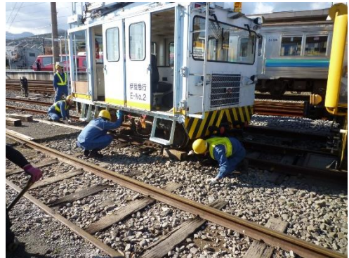
— モーターカー脱線時の復旧訓練 — （電気区）
