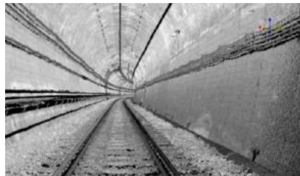
【点群データをもとに作成された3次元図面】
