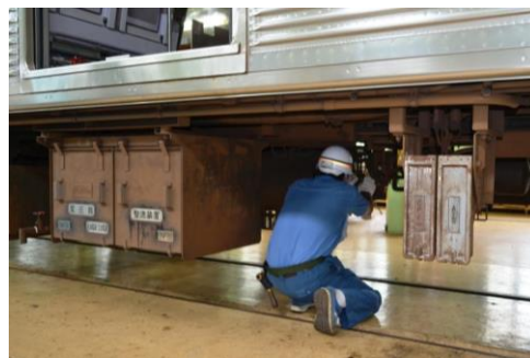
【床下機器検査】
