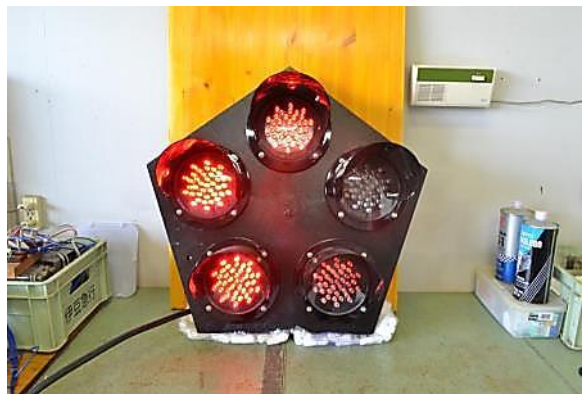
【落石警報機（動作）】
