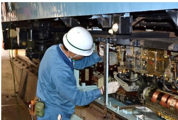
【床下機器の点検】
