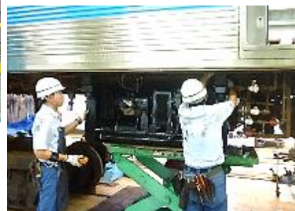
【エアコンプレッサーの整備】
