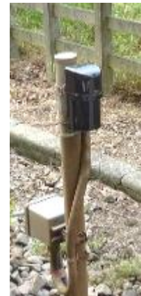
【踏切障害センサー】
